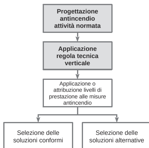
Illustrazione G 2.3: Progettazione antincendio delle attività normate
